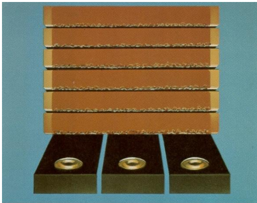
Burnt commutator bar edge
